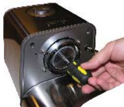
Ta bort spridarfiltret genom att avlägsna krysskraven.
