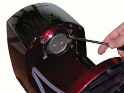
Om spridarfilterhållaren sitter hårt: bänd lätt med en skruvmejsel.
