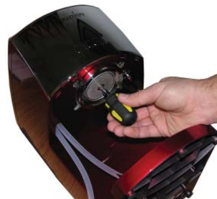
Ta bort spridarfiltret genom att avlägsna krysskruven.
